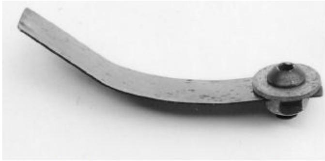
Фото 20: Пружина спуск.рычана, болт, гайка и шайба.
