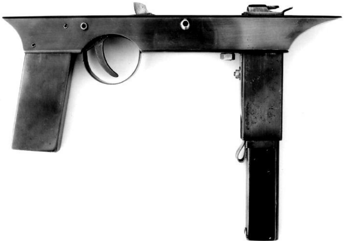
Фото 22. Вид сбоку, полная сборка нижней ствольной коробки.
