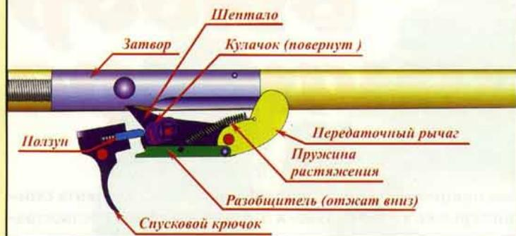
Затвор движется вперед. Переводчик установлен в положение "Автоматический огонь"
