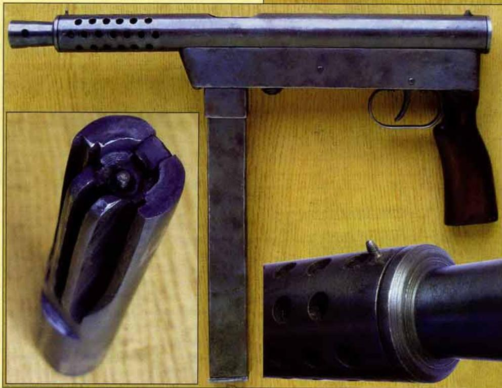
стержня, установлен вертикально на спусковой коробке позади горловины приемника магазина. Сзади в затворе имеется отверстие глубиной 55 мм, в которое входит передний конец возвратно-боевой пружины.
