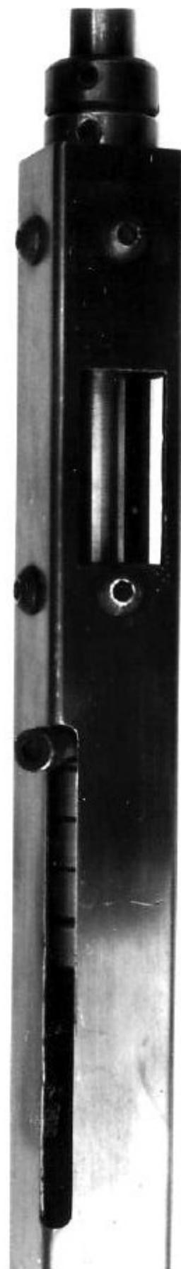
Фото 34: Затвор установлен в законченную верхнюю ствольную коробку.
