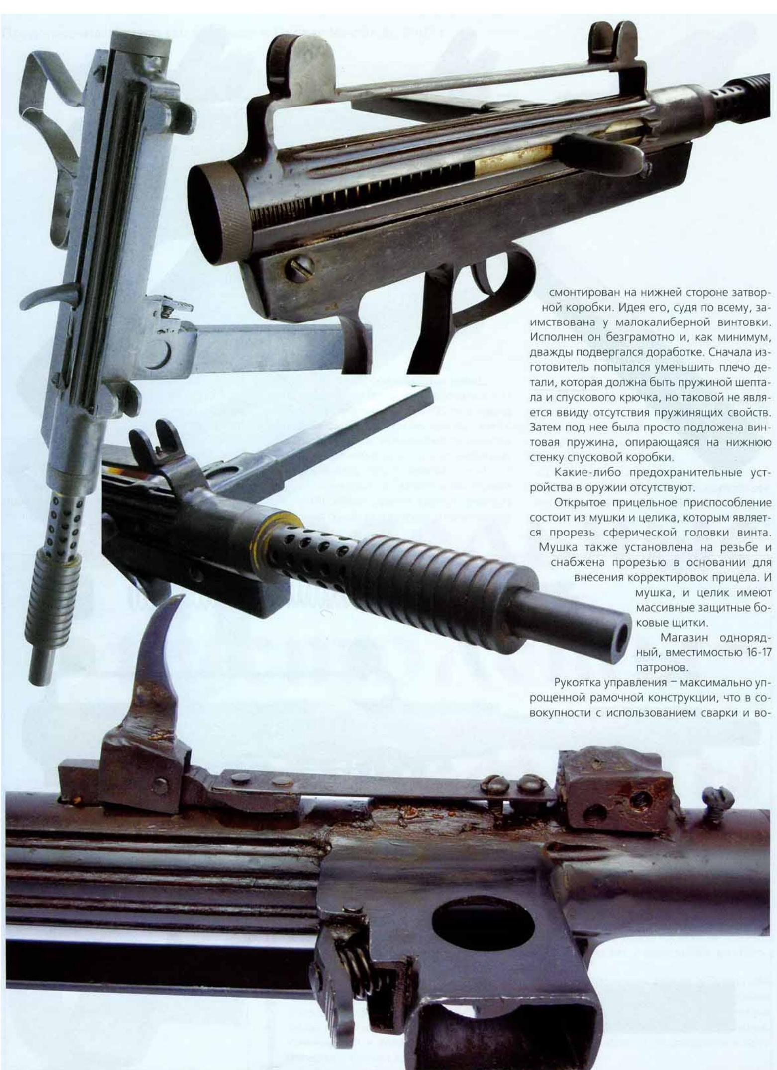
смонтирован на нижней стороне затворной коробки. Идея его, судя по всему, заимствована у малокалиберной винтовки. Исполнен он безграмотно и, как минимум, дважды подвергался доработке. Сначала изготовитель попытался уменьшить плечо детали, которая должна быть пружиной шептала и спускового крючка, но таковой не является ввиду отсутствия пружинящих свойств. Затем под нее была просто подложена винтовая пружина, опирающаяся на нижнюю стенку спусковой коробки.
