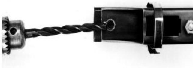
**Фото 24. Сверлим отверстия для винтов крепления коробок.**
