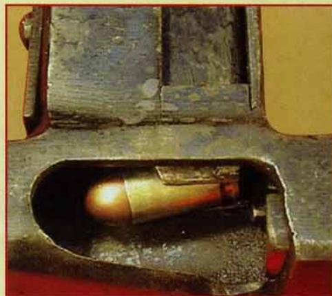
ломка надфиля. Примитивный спусковой механизм, явно скопированный с малокалиберной винтовки, предусматривает ведение только автоматического огня. Окно для выброса стреляных гильз перерезает затворную
