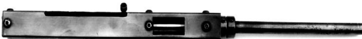
**Фото 40: Полная сборка верхней ствольной коробки**
